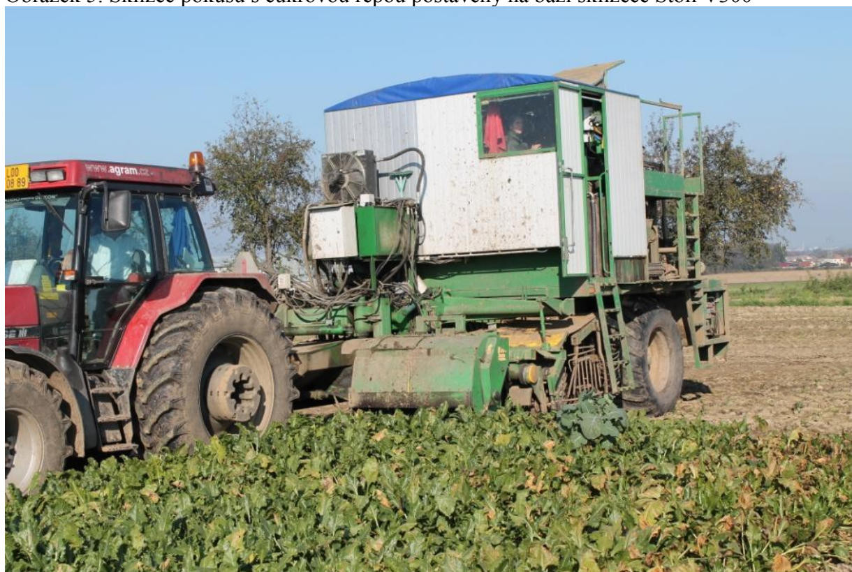
Obrázek 5: Sklízeč pokusů s cukrovou řepou postavený na bázi sklizeče Stoll V300
